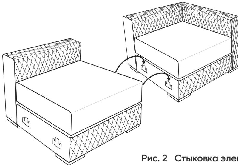
Рис. 2 Стыковка элементов
